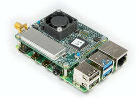
Basisstation für robuste Kommunikation zur Sensoranbindung in Gebäuden © Fraunhofer IIS | Bild in Farbe und Druckqualität: www.iis.fraunhofer.de/pr.
